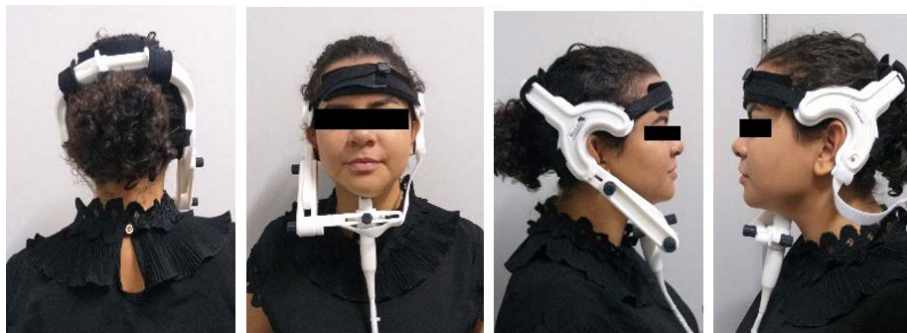
Figura 1 – Indivíduo em pé usando o estabilizador de cabeça com o transdutor acoplado em região submandibular.
