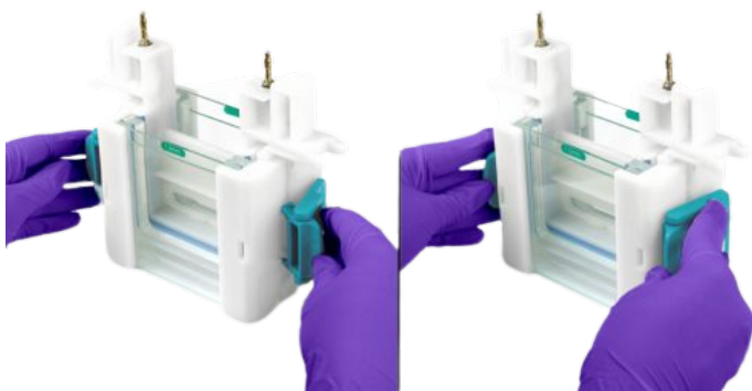
Figura 5 – Procedimento de trava das placas de vidro no suporte
