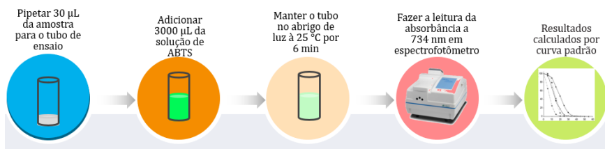
Figura 9 – Determinação a capacidade antioxidante por captura do radical ABTS•+.
