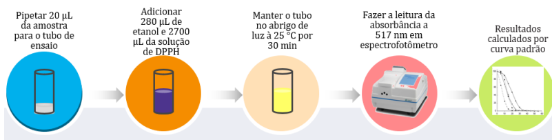
Figura 10 – Determinação da capacidade antioxidante por captura do radical DPPH•.
