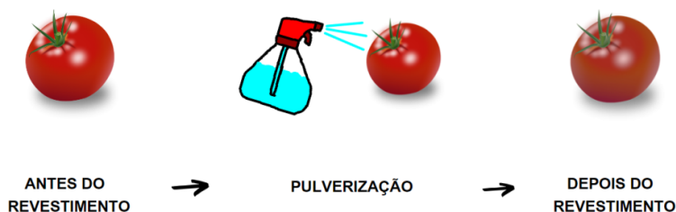
Figura 5 – Procedimento de elaboração de revestimento comestível utilizando a técnica de pulverização.
