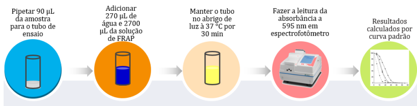
Figura 11 – Determinação da capacidade antioxidante pelo método de redução do ferro (FRAP).
