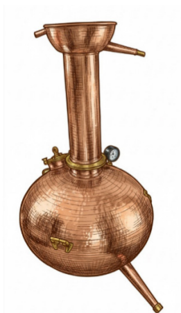
Figura 4 – Alambique tipo cebola com capelo
