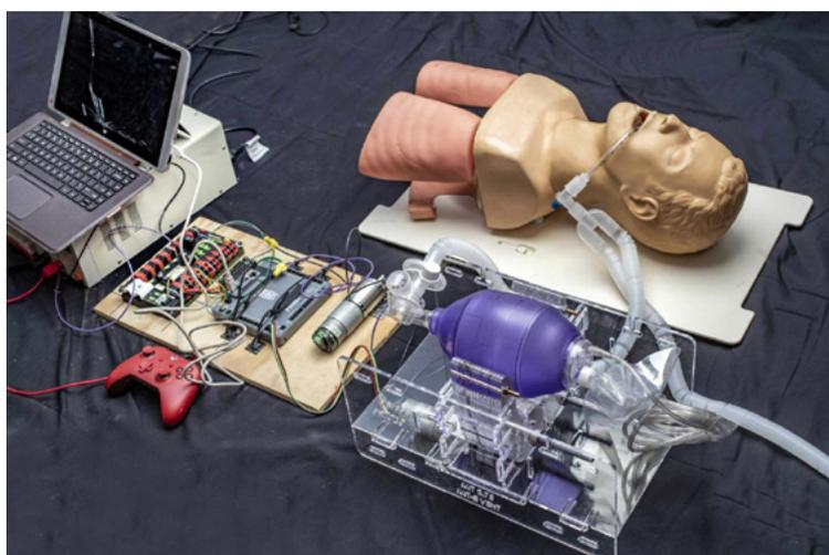
Figura 3 - Configuração usada para testes preliminares do protótipo de baixo custo do ventilador desenvolvido pelo MIT.
