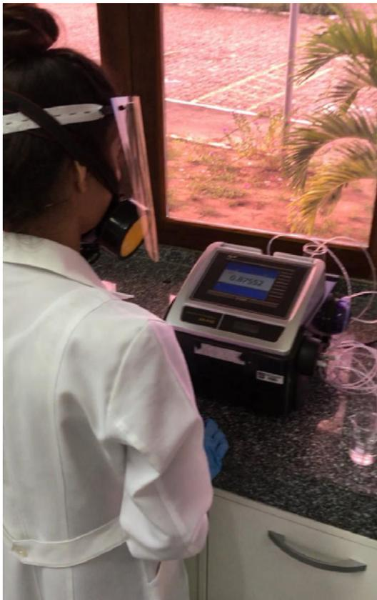
Figura 5 - Medição da densidade no densímetro, realizado no álcool padronizado, antes da liberação para o envase.
