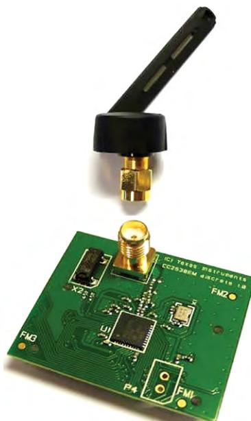
O SoC foi escolhido para ser usado como processador do sistema proposto, ou seja, ele é responsável pelo controle do nó sensor de corrente proposto, recebendo e processando os dados provenientes do circuito de medição e transmitindo esses dados a outros nós sensores ou ao nó sorvedouro, entre outras funções.
