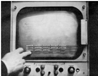
**Figura 13:** Primeiro dispositivo a possuir uma tela sensível ao toque [35].
